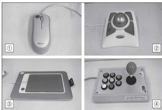
図1 本研究で使用した①マウス②トラックボール③タッチパッド④ジョイスティック
